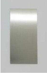
Boeing BSS7434 7.1 Sandviç Korozyon Test Panelleri
